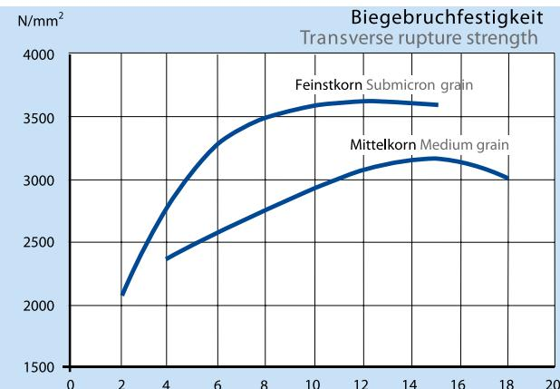
Biegebruchfestigkeit als Funktion des Co-Gehaltes bei unterschiedlichen WC-Korngrößen.
